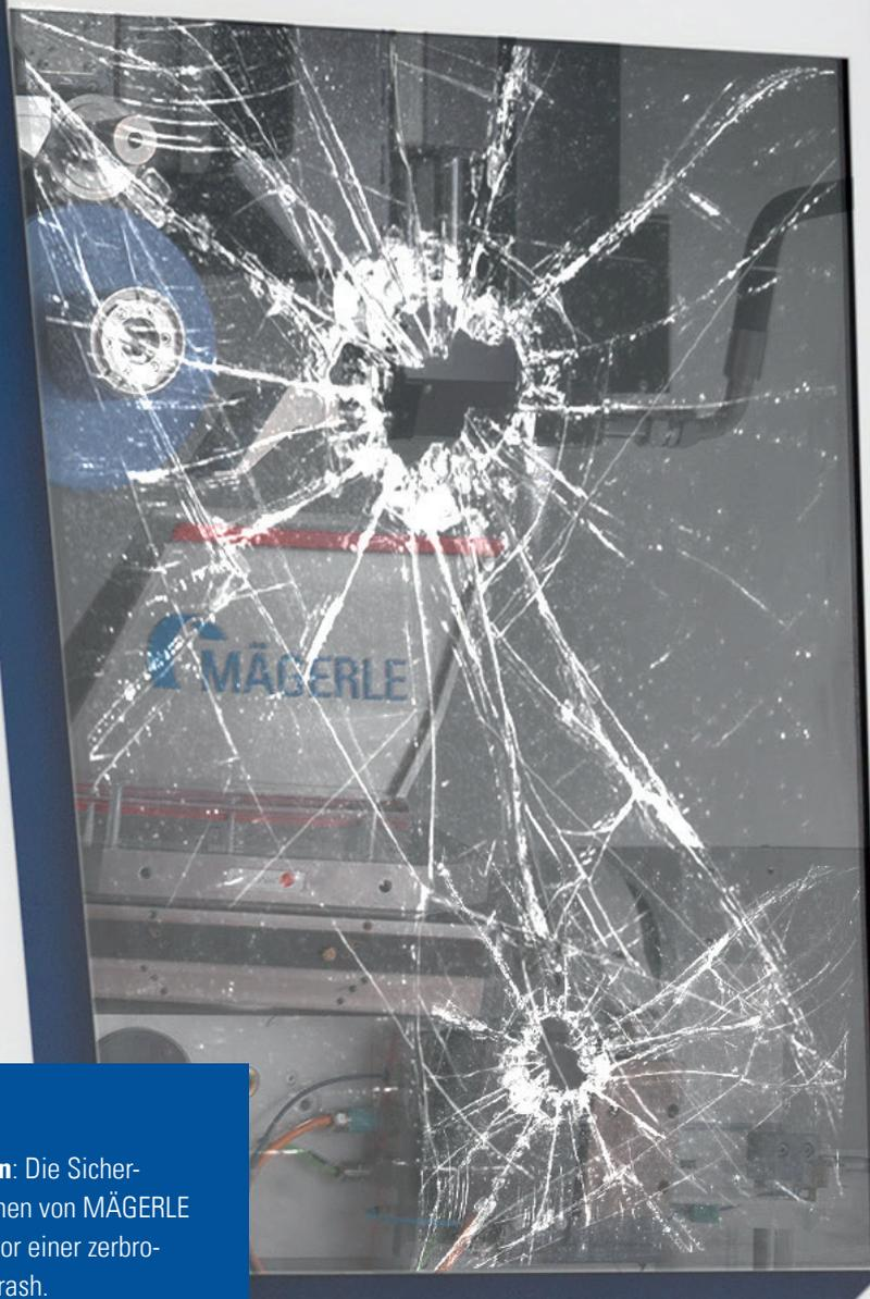
**Geschützt dank Polycarbonat-Sichtscheiben:** Die Sicherheitsscheibe Ihrer Flach- und Profilschleifmaschinen von MÄGERLE schützt den Maschinenbediener unter anderem vor einer zerbrochenen Schleifscheibe nach einem Maschinen-Crash.
