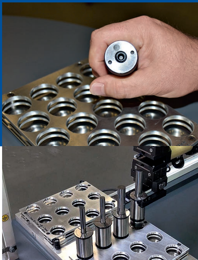
事例: ロット内の異なる工具径の自動再研をするためのRFIDを搭載したコレット (NK)。
