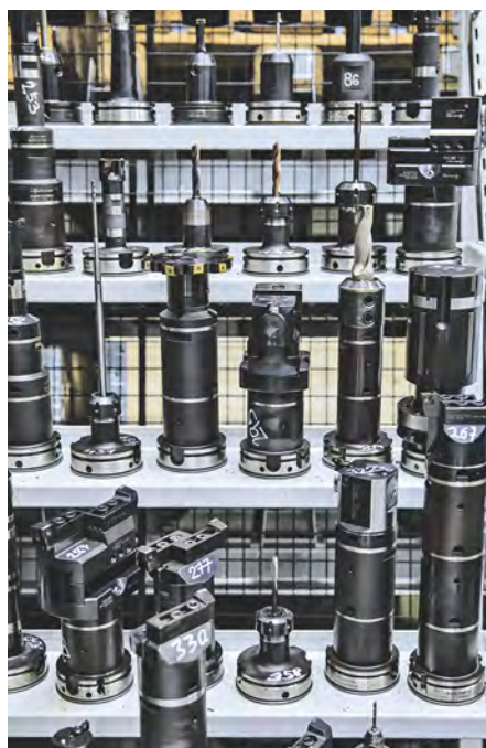
Il dispositivo di cambio utensile del centro di lavorazione è in grado di contenere circa 200 utensili, mentre altri sono inseriti in un caricatore esterno (foto a destra)
